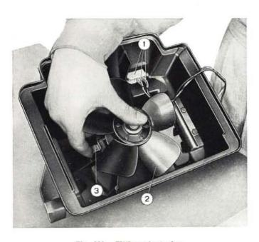
Fig. 309 - Fitting electrofan.
