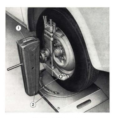
Fig. 234 - Checking camber.
