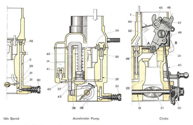
Fig. 143 - Diagrammatic section views of Weber carburetors « 30 ICF » and « 30 ICF 7 ».
