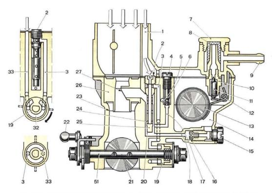
Fig. 142 - Diagrammatic section views of Weber carburetors « 30 ICF » and « 30 ICF 7 ».
