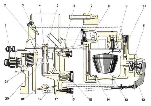
Fig. 147 - Diagrammatic section view of Solex « 30 PIB 4 » carburetor.
