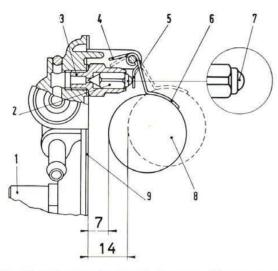
Fig. 146 - Float level adjustment diagram. Weber carburetors « 30 ICF » and « 30 ICF 7 ».
