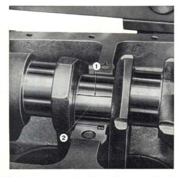
Fig. 76 - Arrangement of calibrated wire on main journal. 1. Piece of « Plastigage ». - 2. Journal.
