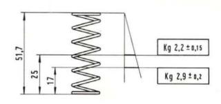
Fig. 109 - Rocker spring checking data.
