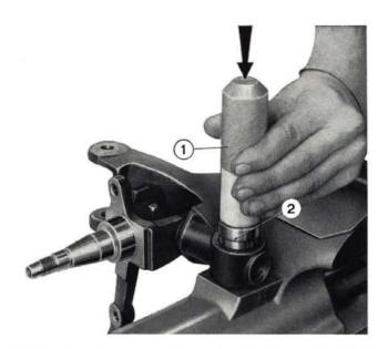
Fig. 225 - Inserting « estendblock » bushing in kingpin housing upper eye. 1. Driver A. 74042. - 2. « Estendblock » bushing.
