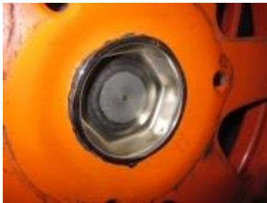
Plaatsen van de wioldoppen
