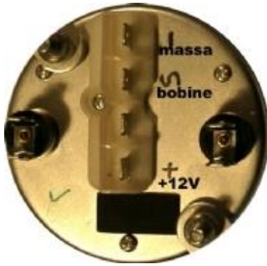
Aansluitingen toerenteller
