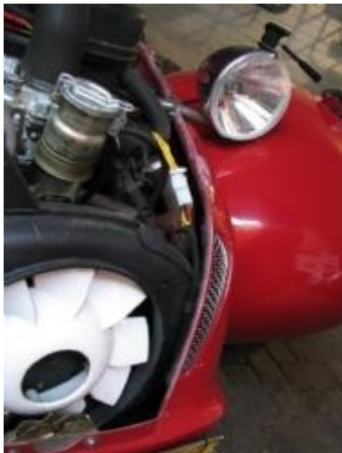
Kabelboom langs koelhuis
