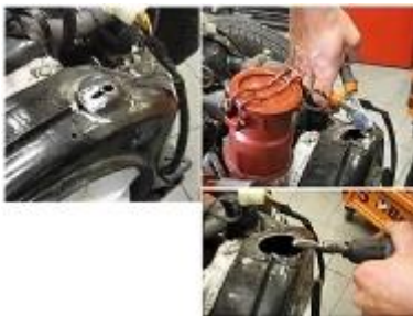
4: Afwerken van het geboorde gat
