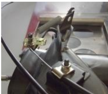
Kachelpot rechts (bevestiging korte kabel)
