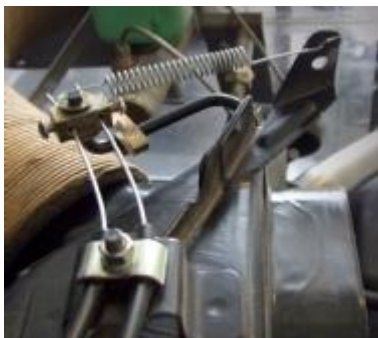
Kachelpot links (bevestiging lange en korte kabel m.b.v. blokje)
