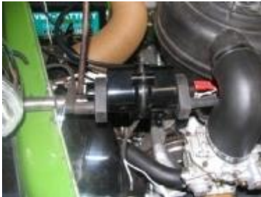
Plaats van de bobine op de beugel
