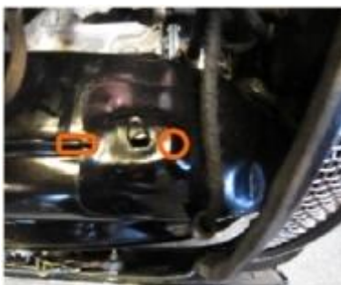
2: Een gat boren en de geveldse rand verwijderen
