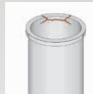
Zylinderlaufbuchsenriss durch Flüssigkeitsschlag 74
