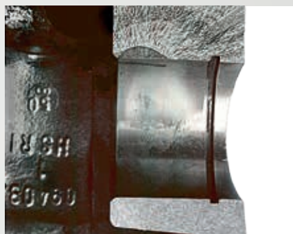
Abb. 3 Querschnitt einer Kolbenbolzennabe
