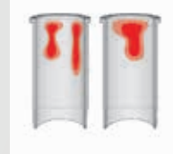
Glanzstellen im oberen Laufflächenbereich 72
