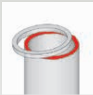
Abgerissener Buchsenbund an der Zylinderlaufbuchse 66
