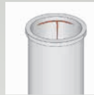
Abgerissener Buchsenbund an der Zylinderlaufbuchse (Vorstufe) 66
