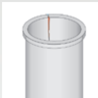
Längsrisse in der Zylinderlaufbuchse 65
