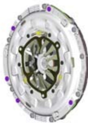
Koppeling bestaat uit een drukgroep en de koppelingsplaat
