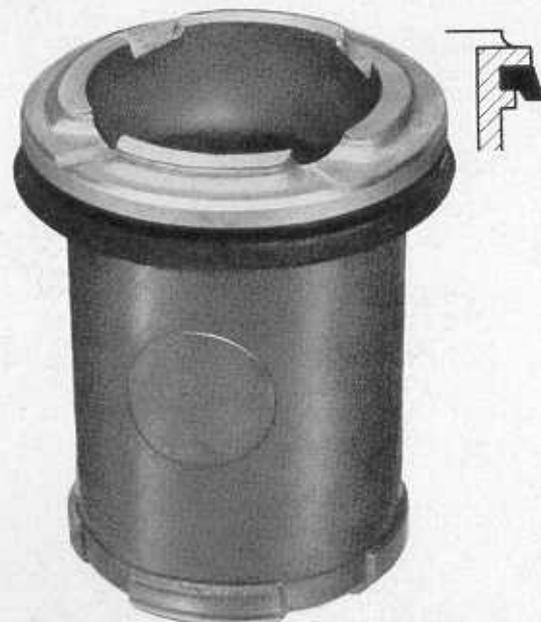
Abb. 7 Neue Dichtringe auf die Kolben setzen.
