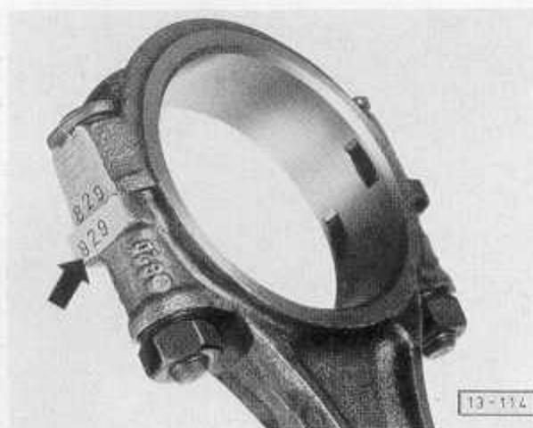
Abb. 8 Pleuelstangen-Einbaulage
