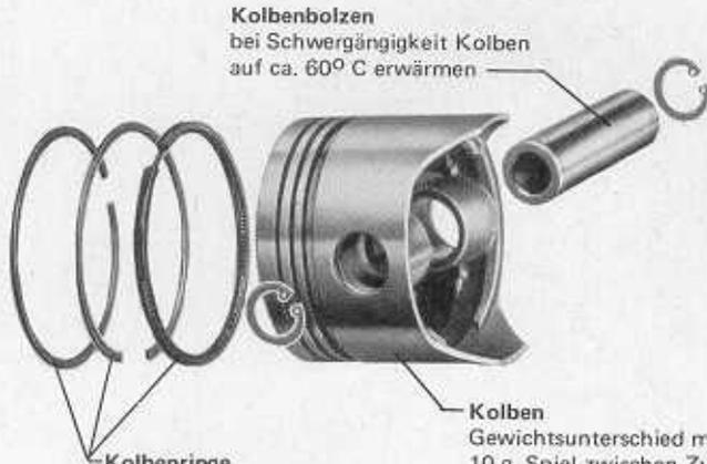
Kolbenbolzen bei Schwergängigkeit Kolben auf ca. 60° C erwärmen
