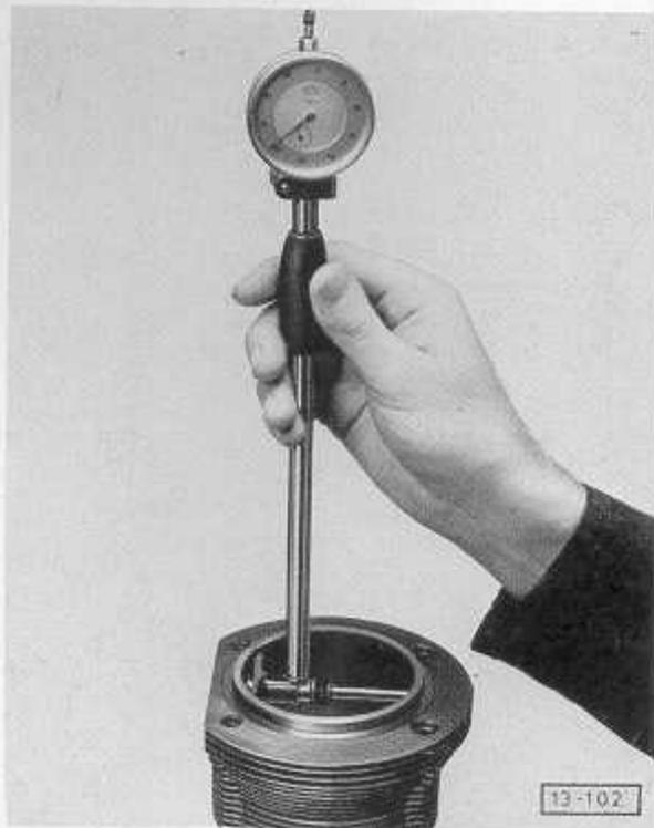
Abb. 5 Zylinderbohrung prüfen
