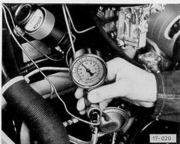
Abb. 5 Öldruck und Öldruckschalter prüfen
