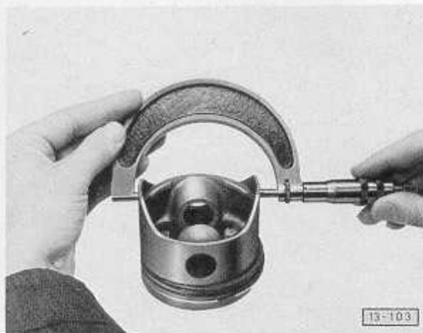
Abb. 6 Kolben  $\phi$  prüfen
