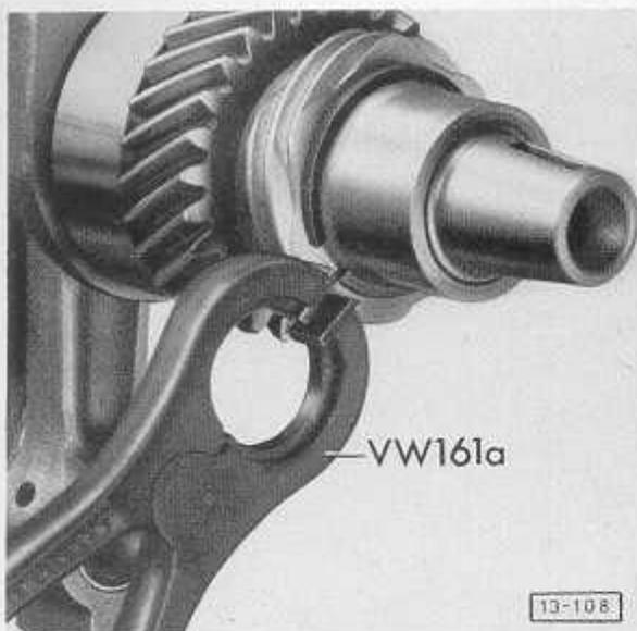
Abb. 4 Sicherungsring ausbauen
