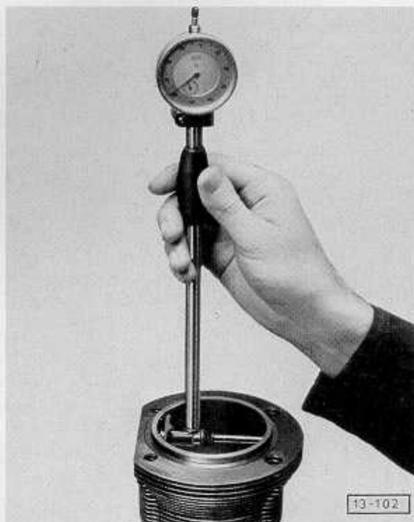
Abb. 5 Zylinderbohrung prüfen
