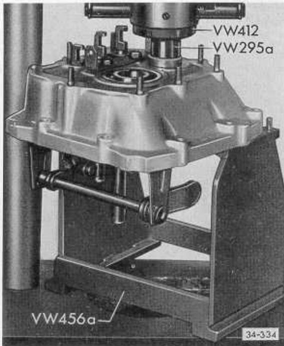
Abb. 6 Nadellager für Triebbling bis Anschlag an den Sicherungsring einpressen.
