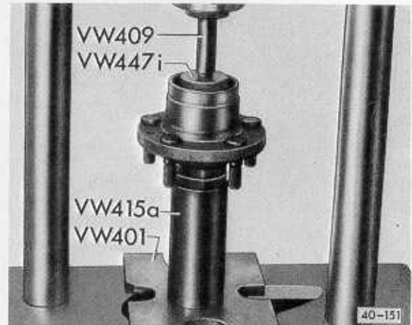
Abb. 4 Außenlaufring für inneres Radlager einpressen
