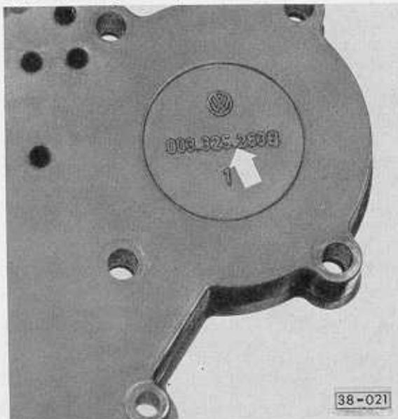
Abb. 3 Kennzeichnung Kanalplatte
