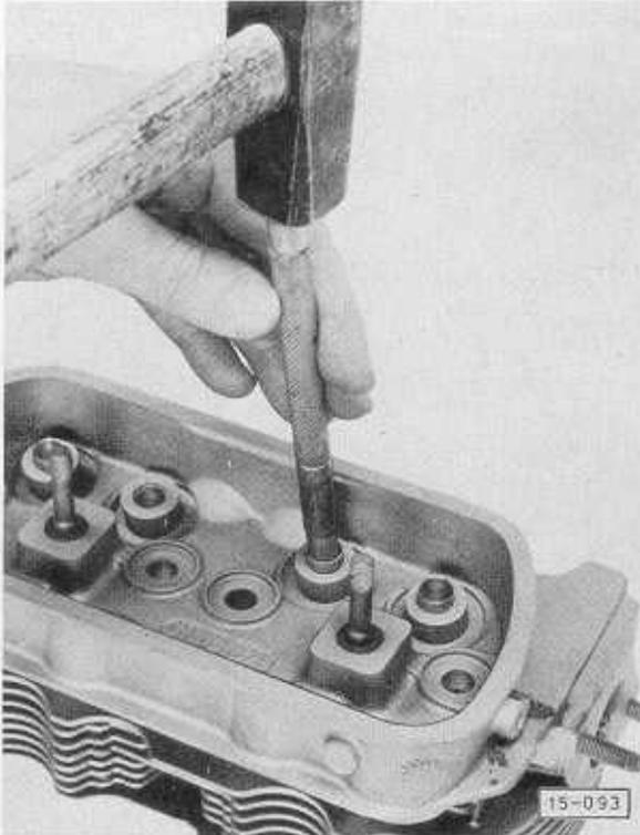
Abb. 16 Ventilführung herauschlagen
