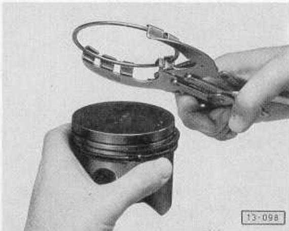
Abb. 1 Kolbenringe aus- und einbauen
