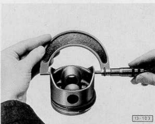
Abb. 6 Kolben  $\phi$  prüfen
