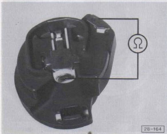
Fig. 1: Checking rotor arm
