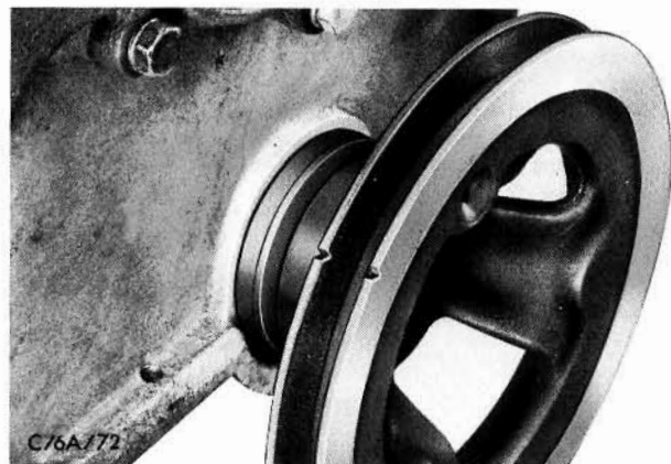
Afb. 338. Distributiedeksel m.b.v. centreer-gereedschap en poelie monteren, "C" motor
