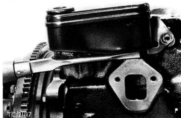
Afb. 33. Olie-afscheider met behulp van een schroevendraaier verwijderen
