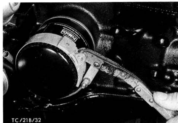
Afb. 75. Oliefilter met speciale sleutel GV-6883 verwijderen
