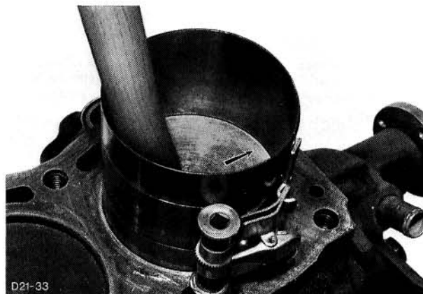
Afb. 103. Zuiger met behulp van klembus monteren
