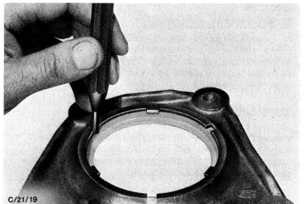
Afb. 188. Oliekeerring uit het distributiedeksel tikken
