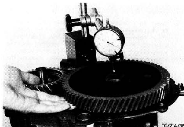
Afb. 154. Axiale nokkenasspeling controleren
