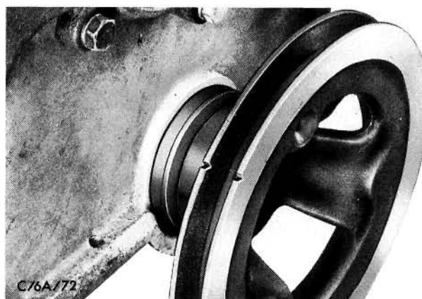
Afb. 155. Distributiedeksel met behulp van speciaal gereedschap G3-6059 en krukspoelie centreren
