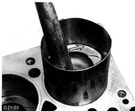
Afb. 60. Zuiger met behulp van klombus monteren
