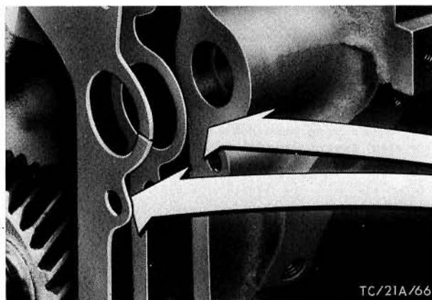
Afb. 151. Tussenplaat met pakking monteren
