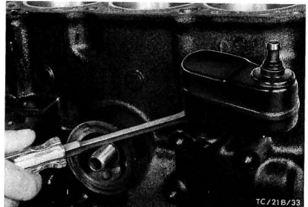
Afb. 80. Olie-afscheider met behulp van een schroevendraaier verwijderen
