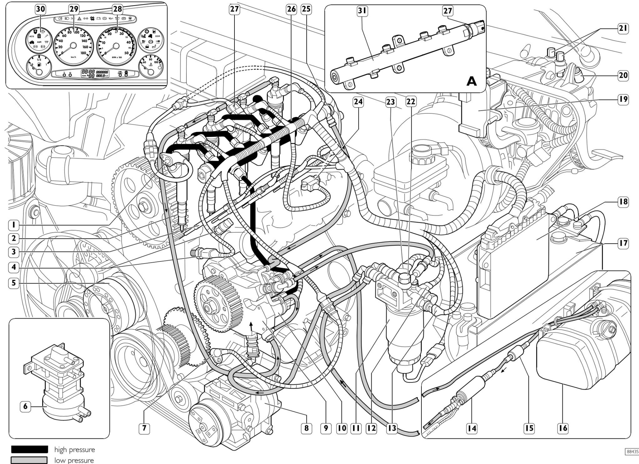
HIGH-PRESSURE ELECTRONIC INJECTION SYSTEM COMPONENTS LAYOUT
