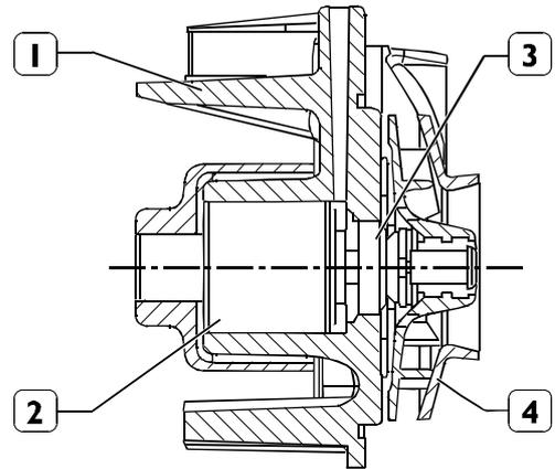
LONGITUDINAL CROSS-SECTION OF THE WATER PUMP
