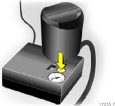
Überschüssigen Reifenluftdruck mit dem Schalter oberhalb der Druckanzeige ablassen.
