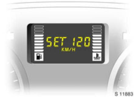
Schalter + - drücken: die Grenzgeschwindigkeit ist nun gespeichert und wird im Bordcomputer angezeigt.
