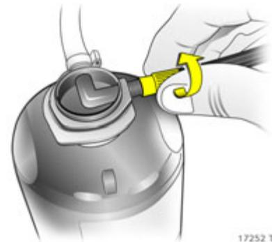
4. Den Luftschlauch des Kompressors am Anschluss der Dichtmittelflasche anschrauben.
