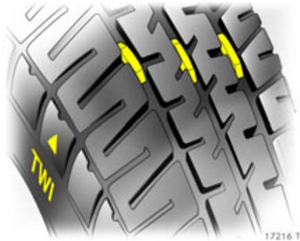
Reifen sollten aus Sicherheitsgründen bei einer Profiltiefe von 2-3 mm erneuert werden. Die gesetzlich zulässige Mindestprofiltiefe (1,6 mm) ist erreicht, wenn das Profil bis zu einem Verschleißanzeiger abgefahren ist. Mehrere Verschleißanzeiger sind in gleichen Abständen im Profilgrund der Lauffläche verteilt. Ihre Lage ist durch Markierungen an der Reifenflanke angezeigt.
