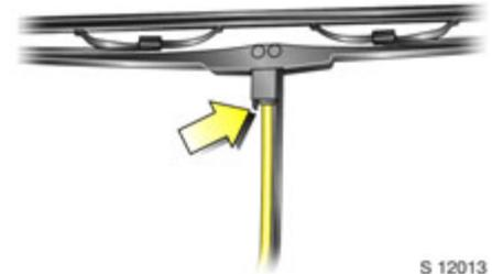
Zum Ersetzen des Wischerblatts Wischerarm anheben und Waschanlagen-schlauch von Düse lösen. Entriegelungshebel betätigen und Wischerblatt ausheben.
