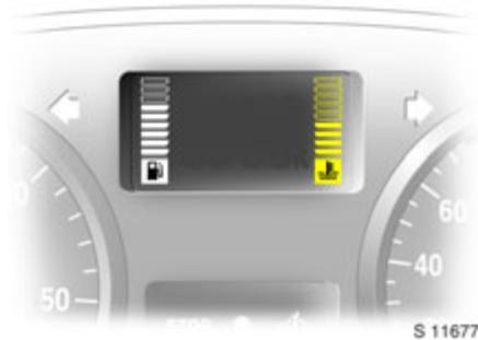
Die Kühlmitteltemperatur wird aus technischen Gründen nur bei ausreichendem Kühlmittelstand angezeigt.
