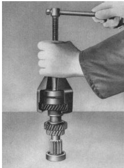
Bild G 12. Rillenkugellager und 4. Gangrad abziehen
