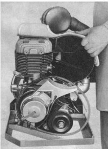
Bild M 13. Kühlluftgehäuse abnehmen
