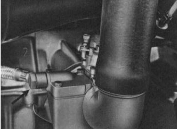
Bild M 59. Kraftstoffleitung abschrauben
