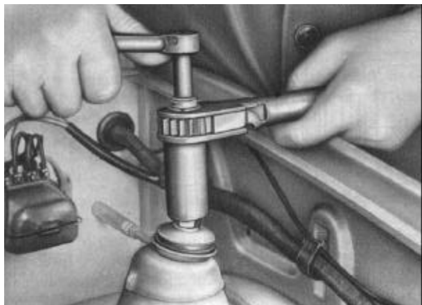
Bild F 38. Stoßdämpferbefestigung lösen
