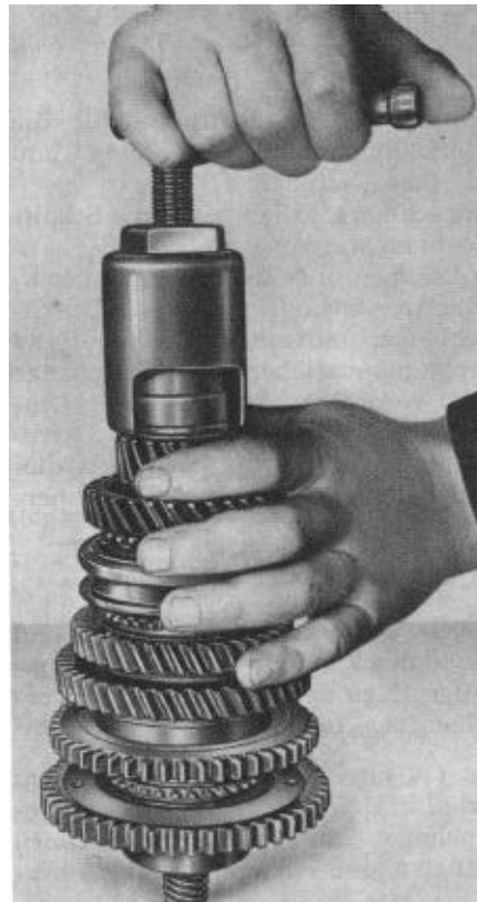
Bild G 16. Innenring vom Zylinderrollenlager abziehen
