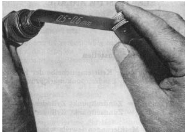
Bild E 4. Elektrodenabstand überprüfen
