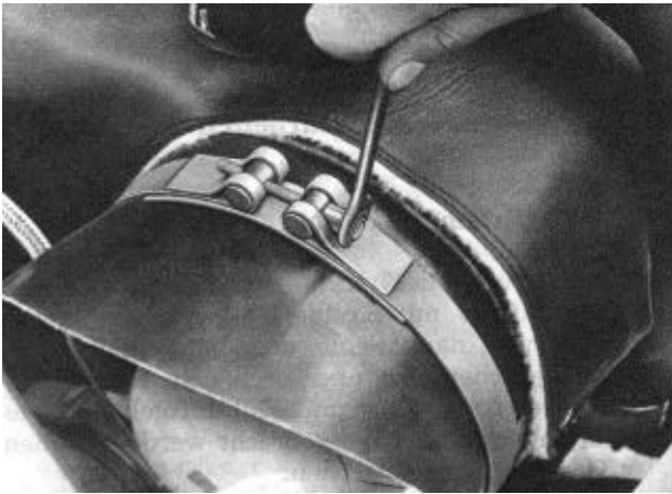
Bild M 48. Spannband lösen
