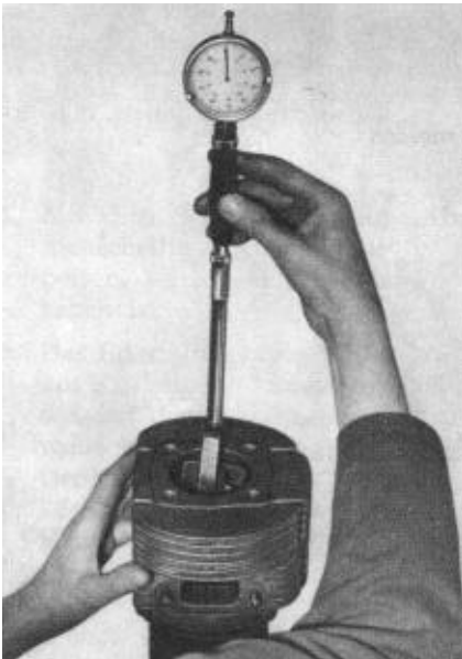
Bild M 36. Zylinderbohrung messen
