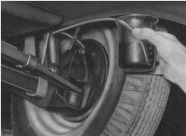
Bild F 55. Bremse entlüften
