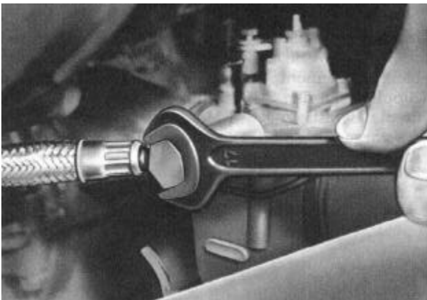
Bild M 4. Kraftstoffleitung abschließen
