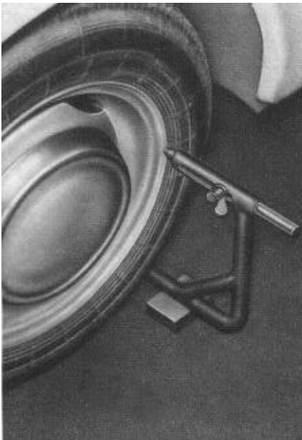
Bild F 21. Vorspur überprüfen
