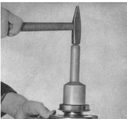
Bild M 28. Kugellager aufschlagen
