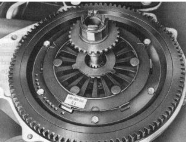
Bild M 74. Mitnehmerscheibe zentrieren
