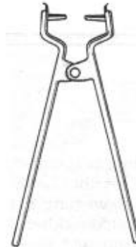
Zange zum Aus- und Einhängen der Bremsbacken
